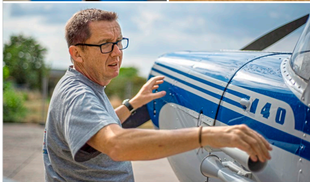
Charakteristisches Merkmal der Cessna 140: die trötenförmigen Venturi-Düsen.
